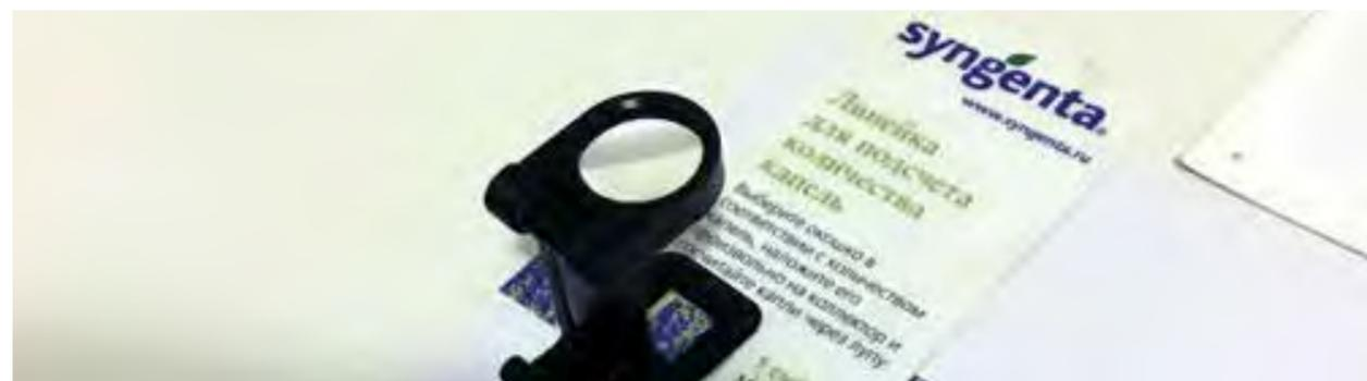
Лупа и линейка для подсчета капель на улавливающей бумаге с результатами опрыскивания
